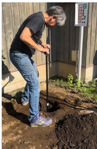
①掘削: ハンドオーガーで直径20cm、深さ55cmの孔を掘ります。
