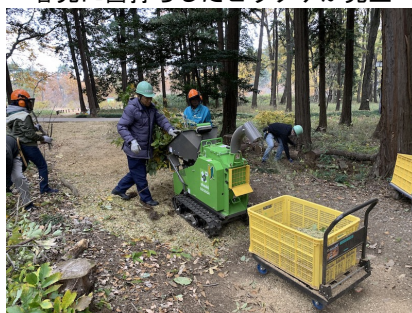
伐採枝や落枝をウッドチップパーにかけ、チップを路面に敷設
