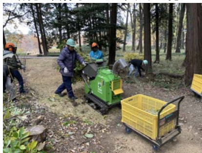
伐採枝や落枝をウッドチップパーにかけ、チップを路面に敷設
