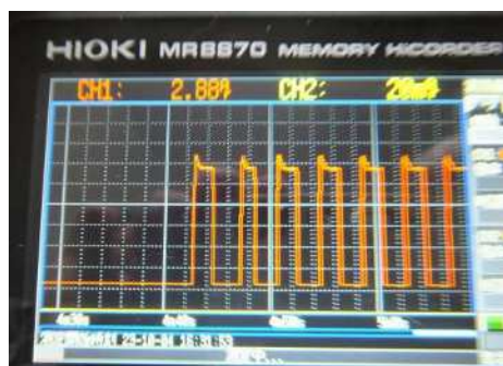
図7 IH電磁調理器の電流波形
