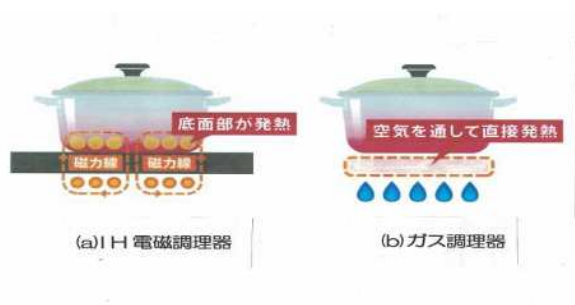
図5 IH電磁調理器とガス調理器の原理
